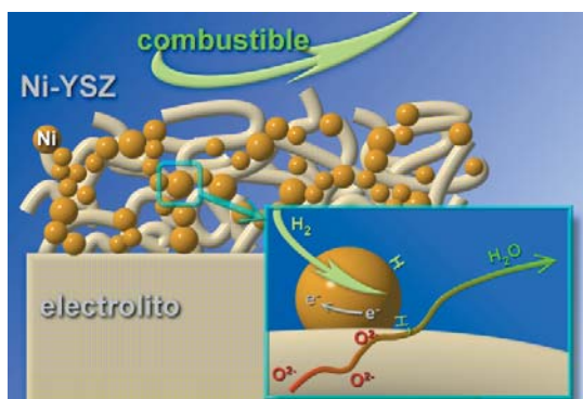
Figura 2. Esquema de un cermet de Ni-YSZ, mostrando las reacciones electroqu micas que tienen lugar en la TPB.
